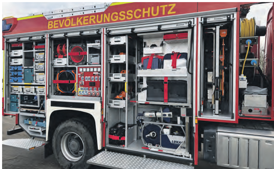
Der neue Rüstwagen (RW) der Feuerwehr Landkirchen: Ein Blick in einen der offenen Geräteräume (hier: G2) zeigt die Vielseitigkeit der Ausrüstung: Von Plasmaschneidern über Motortrennschleifer bis hin zu Spezialwerkzeugen ist alles an Bord, um für jeden Unfall gewappnet zu sein.
