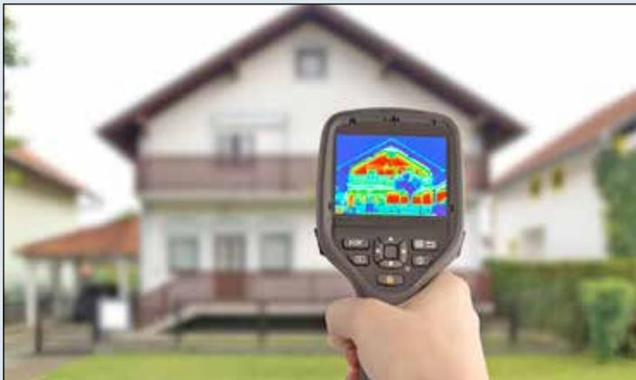
**Die Wärmebildkamera zeigt, wo es im Haus energetischen Sanierungsbedarf gibt. Mit einer richtigen Dämmung können die Wärmeverluste vermieden werden.** Foto: DJD/Brillux/Dario Sabljak - stock.adobe.com
