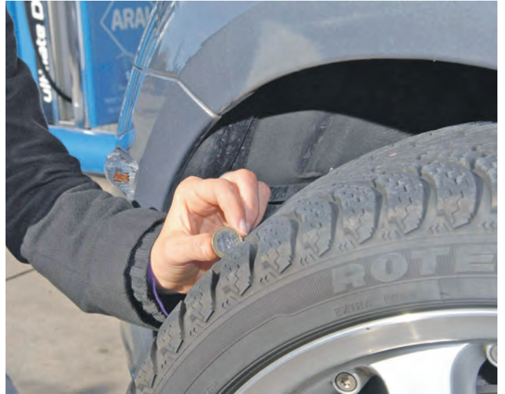
Profiltiefe am Reifen messen: Verschwindet der goldene Rand einer Ein-Euro-Münze, ist alles im grünen Bereich.
