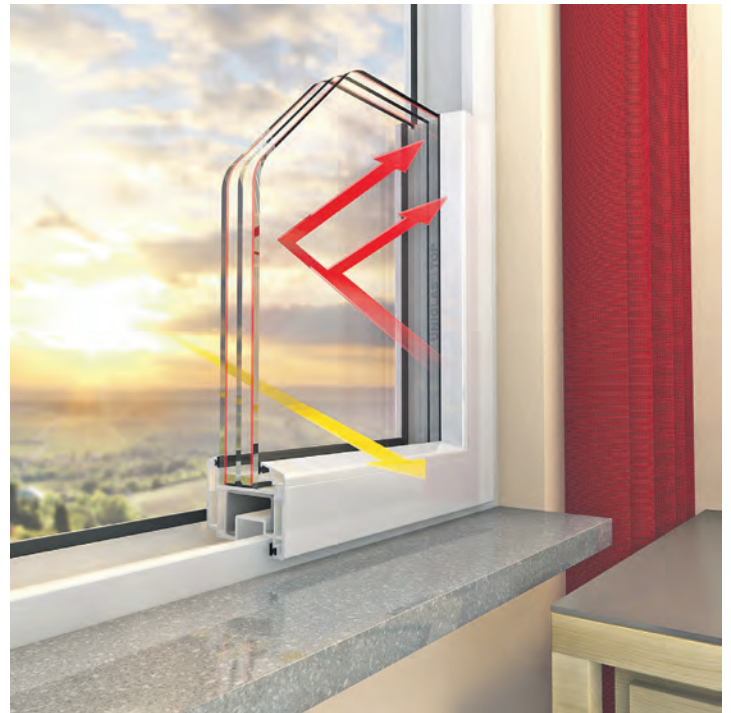
Der Dämmeffekt bei dreifacher Verglasung: Warme Sonnenstrahlen kommen rein, Kälte bleibt draußen.
