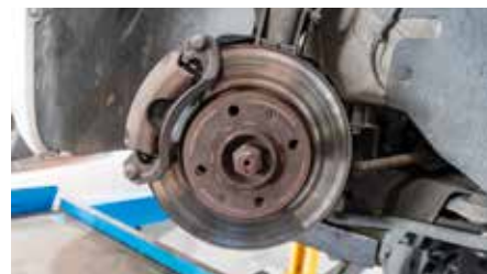
Eine defekte Bremsscheibe
